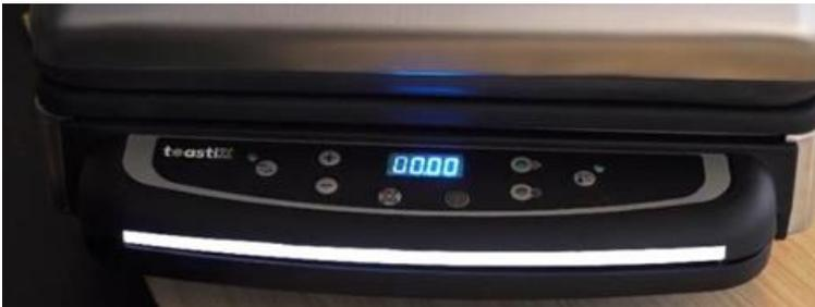
Beim Einschalten der Maschine schaltet sich der LED-Streifen während des Aufheizens bis zum Erreichen der maximal eingestellten Temperatur zunächst mit maximaler Helligkeit ein, verringert dann die Helligkeit, bis er sich nach Erreichen des Aufheizens ausschaltet.
